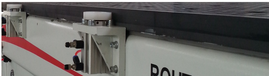
Bild 10. Pneumatische Anschlüsse für X und Y Achse
