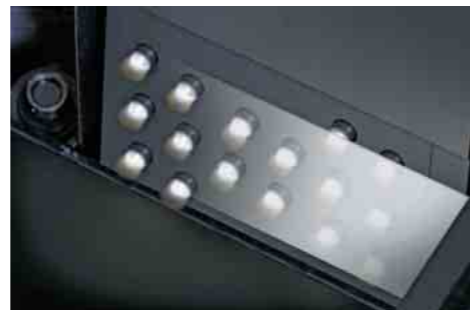
IMA Aggregat zur Plasma-Bekantung und Plasmadüsen (Detail)
