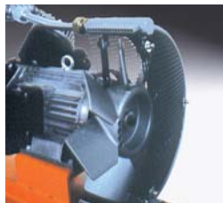
Lüfter mit effizientem Ringkühler
