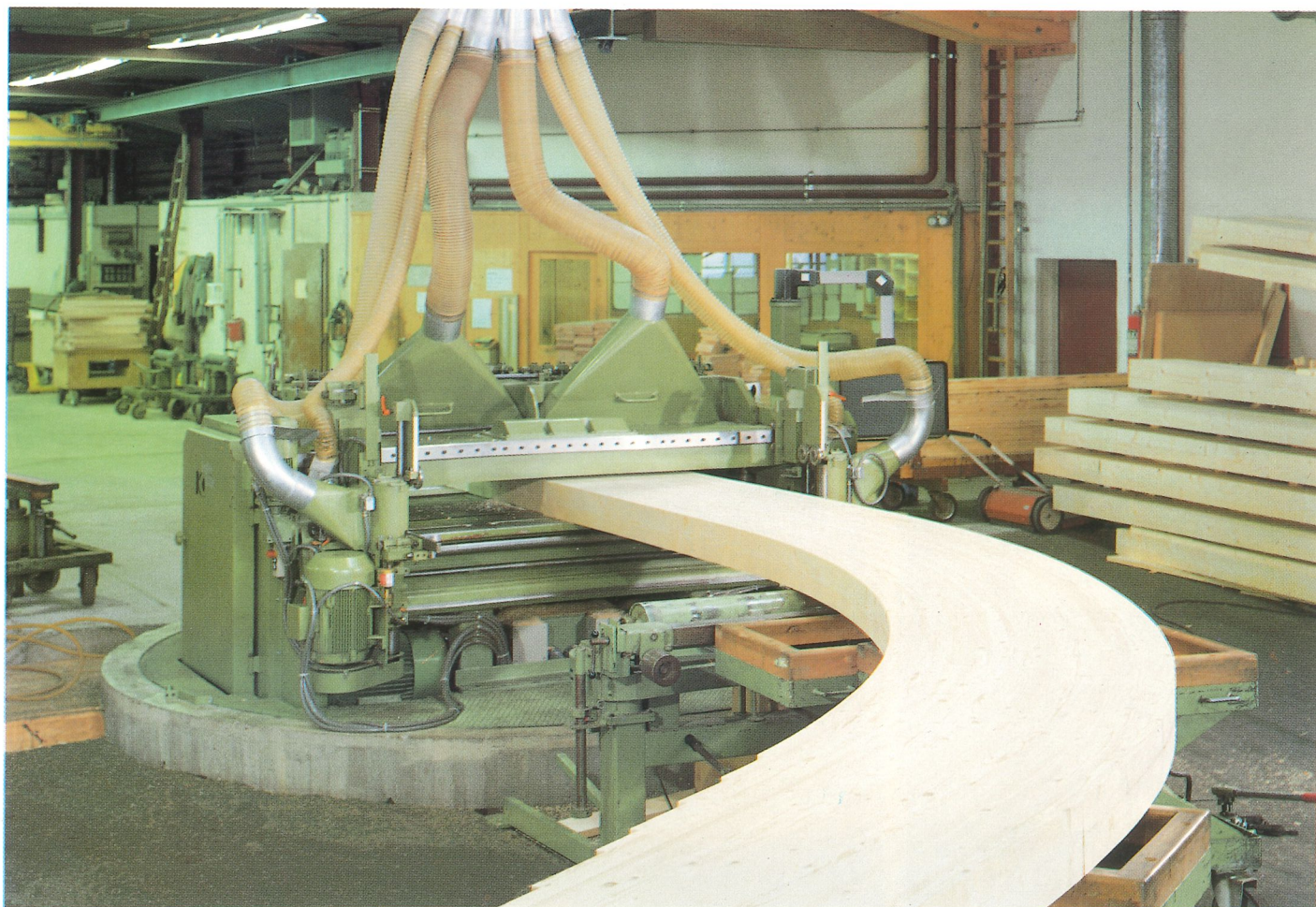
Hobeln von geraden und gekrümmten Leimbindern.
