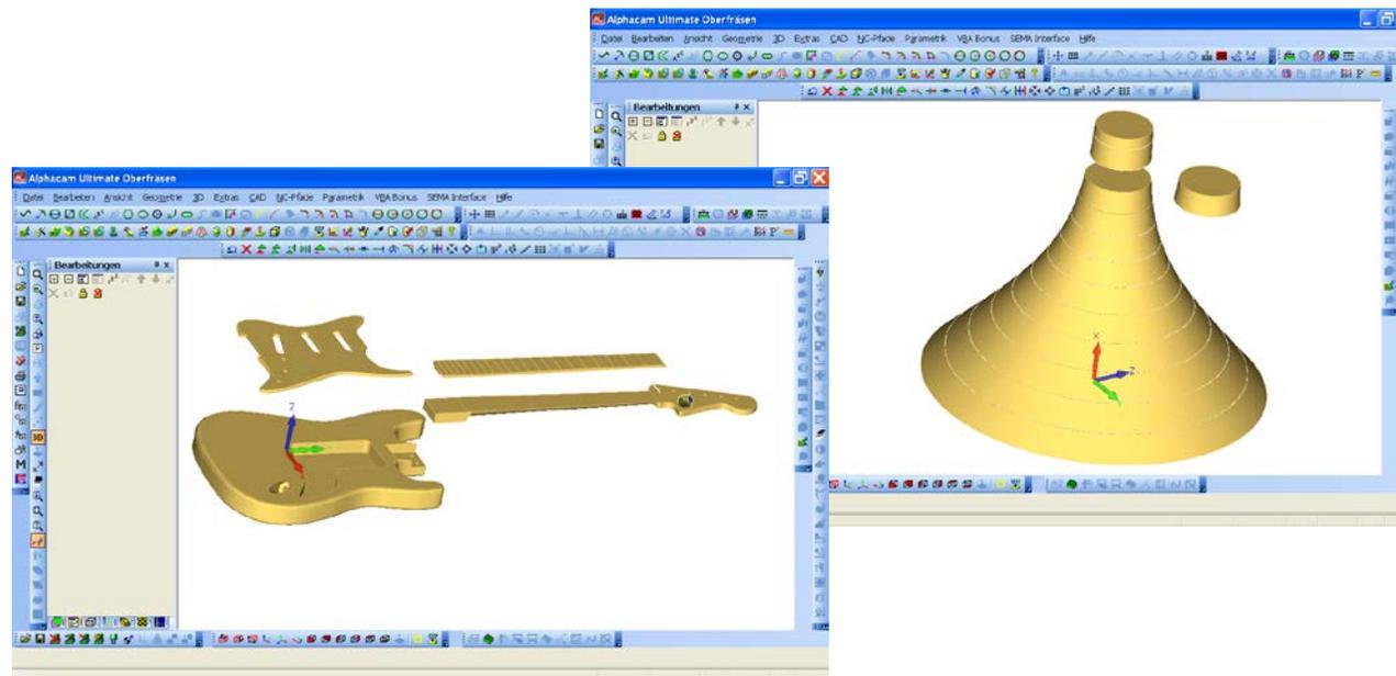
Neben den CAD-Schnittstellen(\*) DXF, DWG, IGES, Rhino, Step, STL und EPS können auch die Solid-basierenden Dateiformate Parasolid, Solidworks, Solidedge, Unigraphics, Inventor, SAT/ACES/DWG sowie ProE und das Catia Solid als Solidobjekte in AlphaCAM eingelesen und bearbeitet werden. Durch die automatisierte Featureerkennung von Bohrungen, Taschen etc. kann so die Programmierzeit drastisch verkürzt werden.
