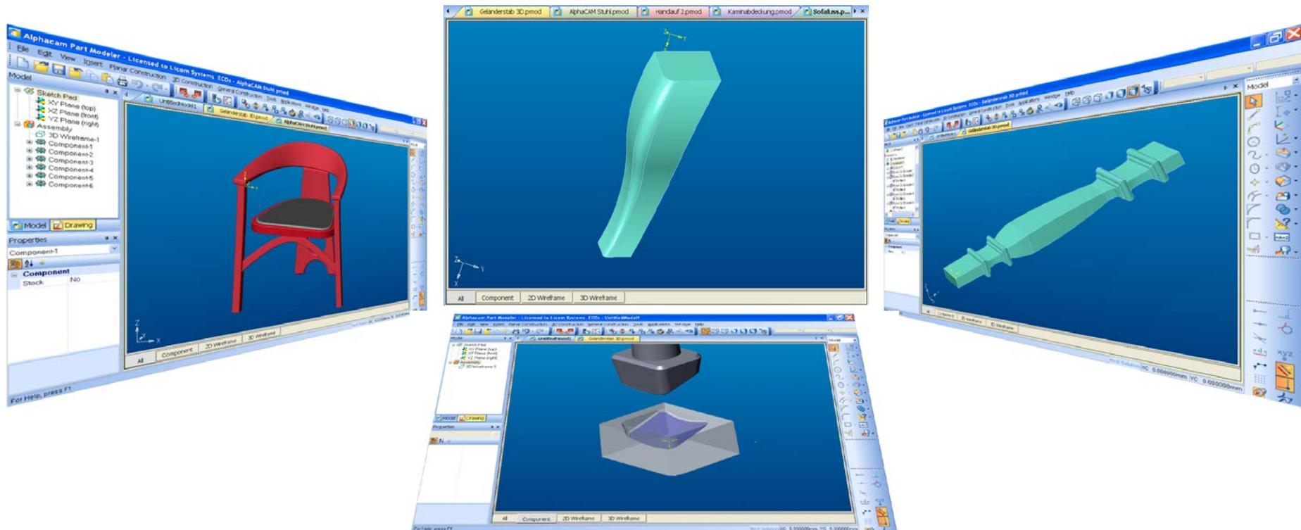
Alle Bauteile lassen sich parametrisch anlegen, so dass Maßvarianten schon bei der Konstruktion einfach zu berücksichtigen sind. Das Erzeugen von Negativformen (hier grau dargestellt) für Aufspannungen von Formteilen erfolgt durch die einfache Subtraktion von Körpern.
