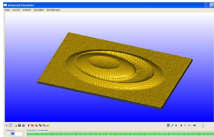
Mit der Projektion von 2D NC-Bahnen auf 3D Flächen lassen sich die so erstellten 3D Körper komfortabel beschriften oder verzieren. Ebenso können einmal programmierte Bearbeitungsfolgen als NC-Bearbeitungsmakros abgespeichert und dann per Mausklick auf beliebige zukünftige Werkstücke übertragen werden. (Stichwort: wissensbasierte Fertigung).
