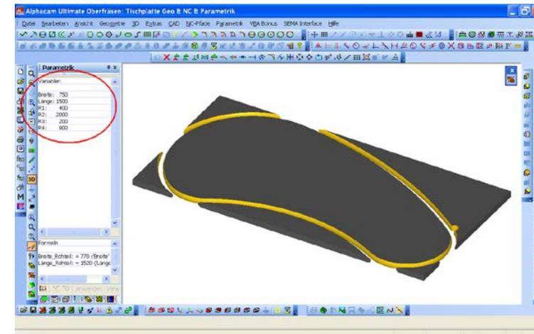
Neben der reinen „Plattenparametrik“ (z.B.  $Z = \text{Dicke}/2$ ) können auch geometrisch aufwendige Konturen ohne Schnittpunktbe-rechnungen parametrisiert werden. Die parametrischen Bedingungen sorgen dafür, dass z.B. Bohrungsreihen, erst ab einer bestimmten Breite zusätzlich gebohrt werden.
