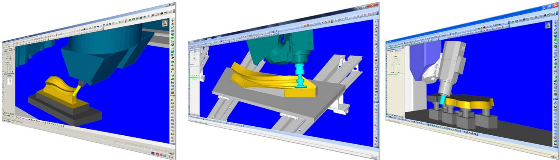
Diese Möglichkeit ist zum Beispiel bei Maschinen mit einem kardanischen Kopf interessant, da hier bedingt durch die Maschinenkinematik gegebenenfalls große Bewegungen von der Fräskopfgeometrie zurückgelegt werden.
