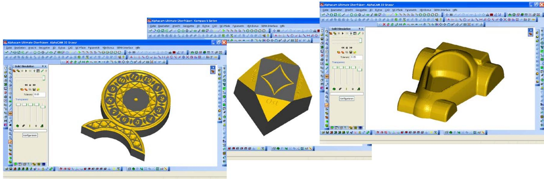
Besondere Features wie das automatische Finden einer Grenzkontur oder das Updaten der NC-Pfade per Knopfdruck (z.B. falls sich die zugrunde liegende Geometrie konstruktion verändert hat) sind hier -neben anderen- als erweiterte 2D Befehle verfügbar.
