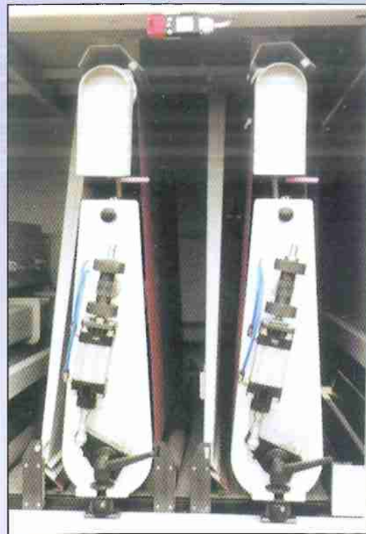
Grupos calibrador-lijador con rodillos de 180 Ø mm (std.) dotados con exclusión neumática (opcional)
