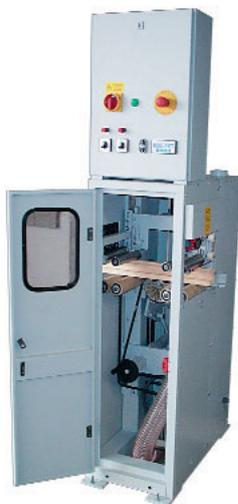
**Der MultiMaster DS** ist eine kleine Maschine zum Schleifen der seitlichen Wange. Eine mit kurzen Schleiflamellen bestückte Disc schmiegt sich an das leichte Profil sauber an. Die Maschine ist sehr kurz gehalten und kommt idealerweise direkt vor dem DoubleMaster oder dem CrossMaster zum Einsatz.
