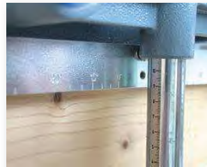
Der vertikale Randabstand kann über eine Skala exakt ein- gestellt werden.
