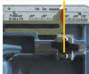
Einfach die Maschine auf Anriss-Kerveneck positionieren.
