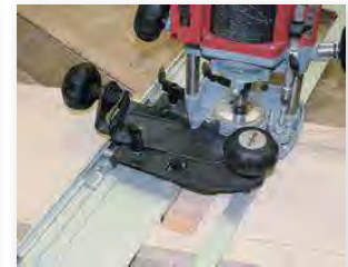
Das Treppenwangen-Fräsergerät im Sonderzubehör für Ausfräsungen von 640 x 60 mm.
