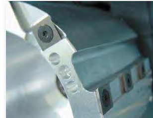
Der neue Fräskopf mit seinen Hartmetall-Wendepplatten für extreme Zerspanung bei optimalem Spänefluss.
