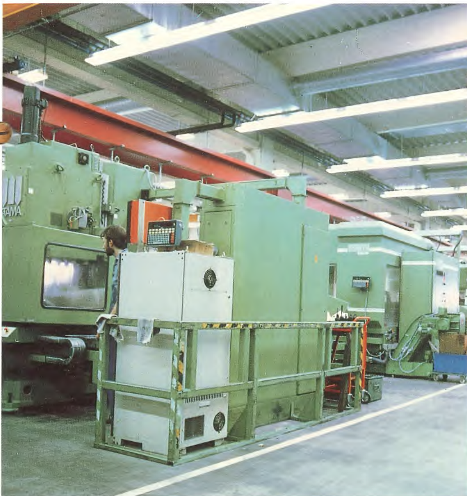
CNC-gesteuerte Bearbeitungszentren im DNC-Verbund mit Programmierplatz.
