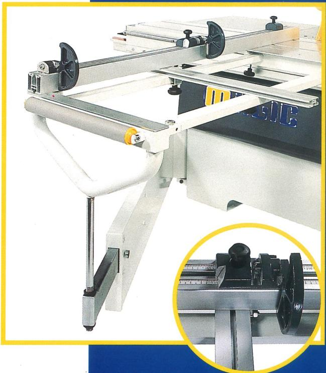
Per i tagli inclinati viene fornita di serie una guida che consente tagli di lunghezza fino a mm 2.050. La guida ruota su un fulcro ed è bloccabile con un semplice pomolo sul secondo binario del carrello in qualsiasi angolo compreso tra -30° e +45°. A richiesta viene fornita una squadretta di precisione per tagli angolari estremamente pratica per la misurazione di pezzi aventi diversi angoli di taglio.
