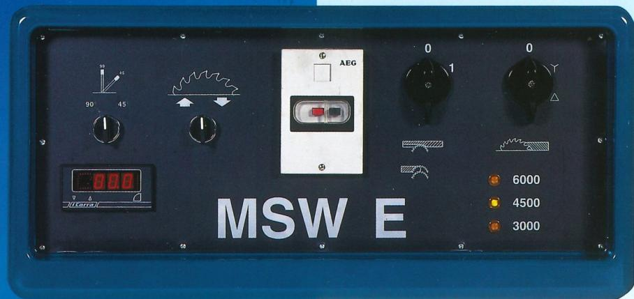
Nel modello MSW-E due interruttori comandano in maniera rapida ed efficace la regolazione elettrica in altezza e l'inclinazione della lama. L'angolo d'inclinazione della lama è riportato in maniera ben visibile su un lettore digitale.
