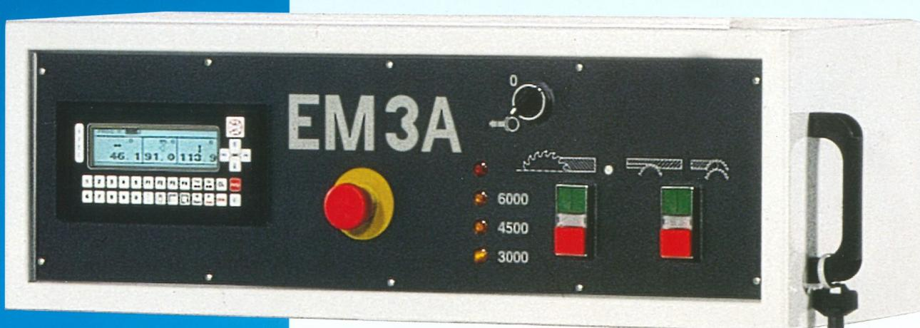
Nel modello EM i comandi si trovano tutti su un quadro pensile. Nel pannello di controllo sono fissati i pulsanti di avviamento automatico delle lame, il lettore digitale dell'angolo d'inclinazione della lama, il lettore della velocità di rotazione inserita della lama, il pulsante di emergenza ed il programmatore con video grafico a cristalli liquidi dal quale si programma oltre al posizionamento della squadra piano, anche sollevamento ed inclinazione della lama.
