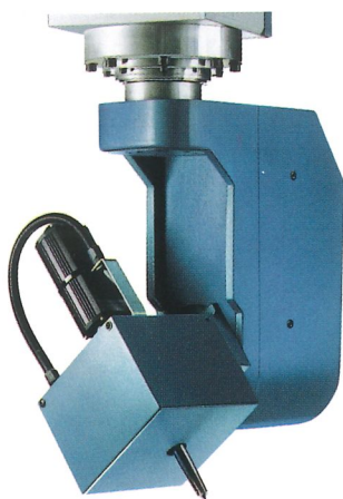
Ultraschall-Schneideeinrichtung für den CNC-Zuschnitt von nicht fräsba- ren Werkstoffen.
