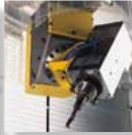
Frässpindel HSK F 63 20/26 kW
