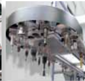
Kettenmagazin horizontal mit 33 oder 51 Plätzen
