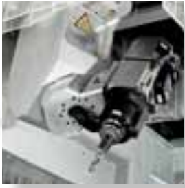
Frässpindel HSK F 63 7,5/10 oder 12/15 kW
