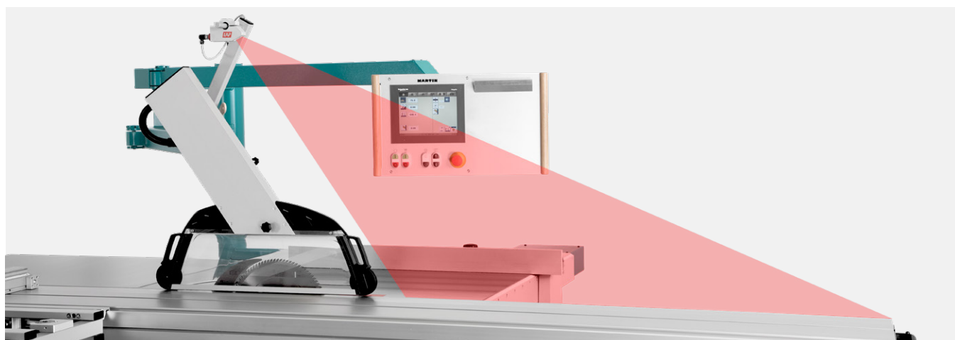
Laser indiquant la ligne de coupe
