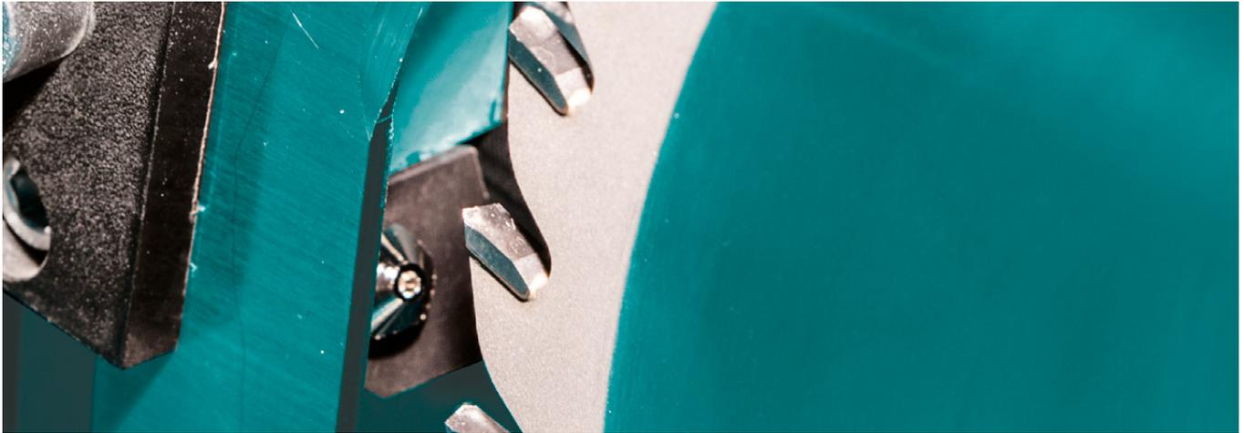
Dispositivo di lubrificazione a freddo con quantità minima
