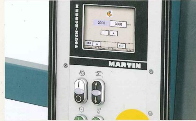
Stufenlose Drehzahlregelung für das Hauptsägeblatt T6076
