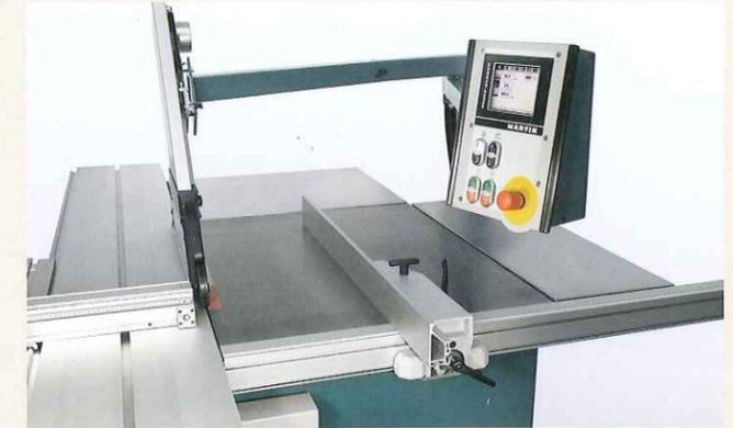
Elektromotorische Positionierung des Parallelanschlages T6090
