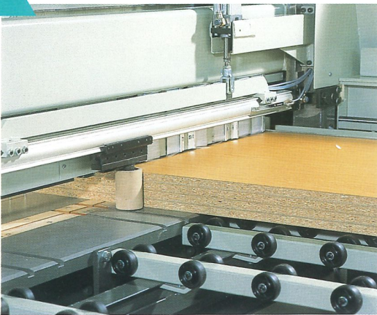
Oben: Paketklemmer im Einsatz Unten: Anpreßvorrichtung
