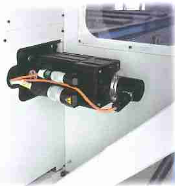
Beidseitiger Servoantrieb, über schrägverzahnte Zahnstangen in der Y - Achse
