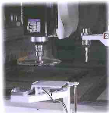
Spezielle Werkzeugwechselsysteme für große Sägeblätter oder Mehrspindelköpfe runden die Flexibilität ab
