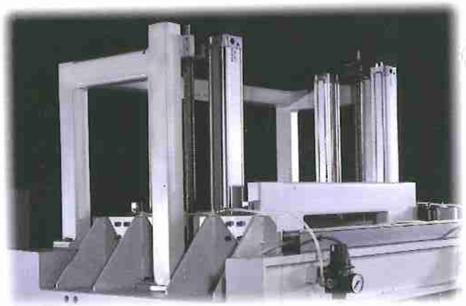
Zwei Kugelrollspindeln in der Z – Achse sorgen für eine hochgenaue Bearbeitung
