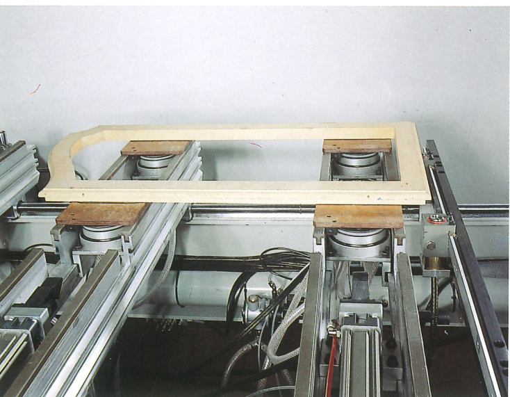
Der Einsatz von Spezialvorrichtungen gewährleistet auch die Fixierung von Werkstücken mit außergewöhnlichen Abmessungen.
