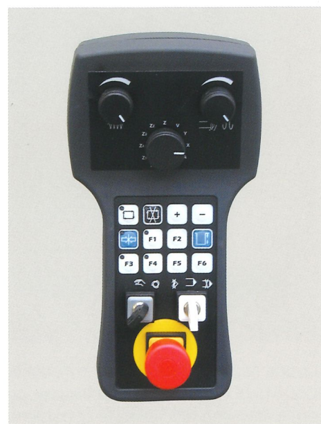
Pigna di controllo per la gestione delle principali funzioni macchina.
