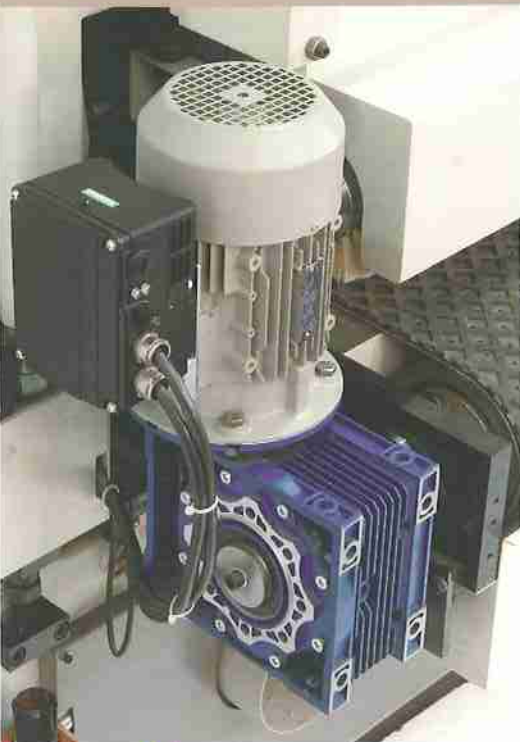
*Detalle motovariador electrónico suministrado de serie con la máquina. *Detail of the electronic motovariator supplied with the machine.
