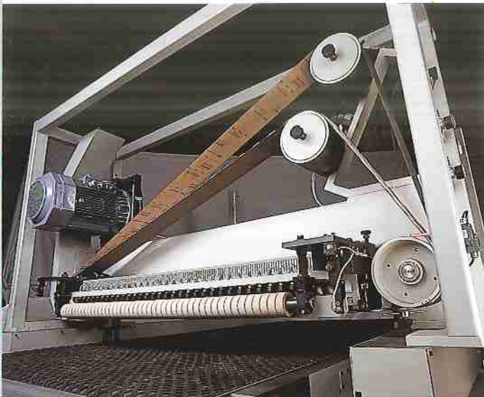
*Grupo patín transversal con banda de acompañamiento, barrera de detectores y sopladores rotativos de limpieza. *Transversal pad group with coupling belt, detectors barrier and cleaning rotative blowers.
