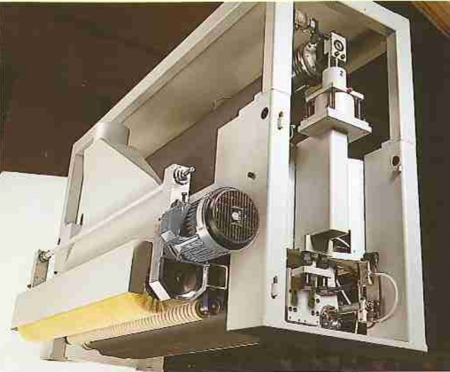
*Vista posterior grupo patin longitudinal con cepillo de limpieza. *Back view of the longitudinal pad with cleaning brush.
