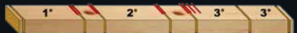
Corte optimizado sobre tres calidades distintas como máx. con marcado sobre un solo lado.
