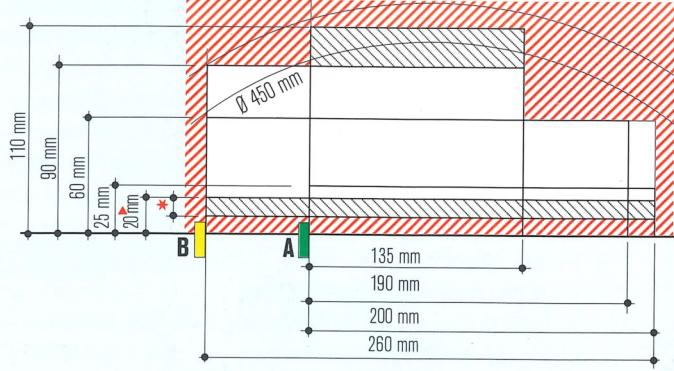
A • B = Posizione della sponda - Fence position - Position Anschlag - Position du guide - Posición de la guía
