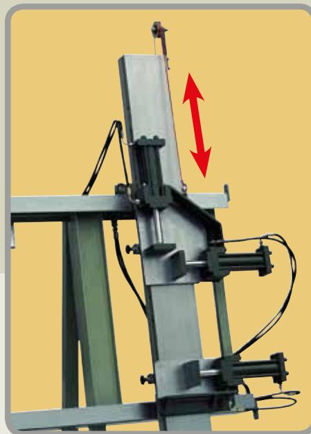
I cilindri scorrono su piastre a cui viene fissata anche la squadra di controbattuta. In questo modo l'operatore, con una sola operazione, posiziona due elementi dello strettoio.
