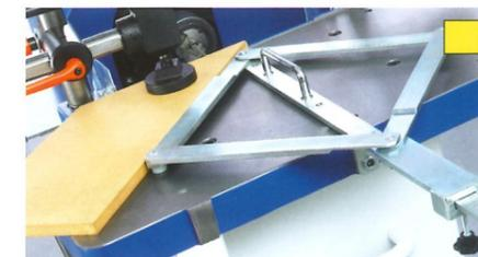
Doppelwinkelverstellanschlag, stufenlos einstellbar 22,5 - 75°
