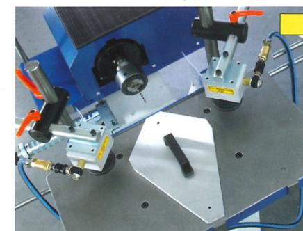
Spannzylinder pneumatisch mit Handschiebeventil am Zylinder
