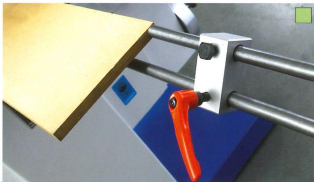
Werkstückanschlag bis 1500 mm lang, stufenlos einstellbar
