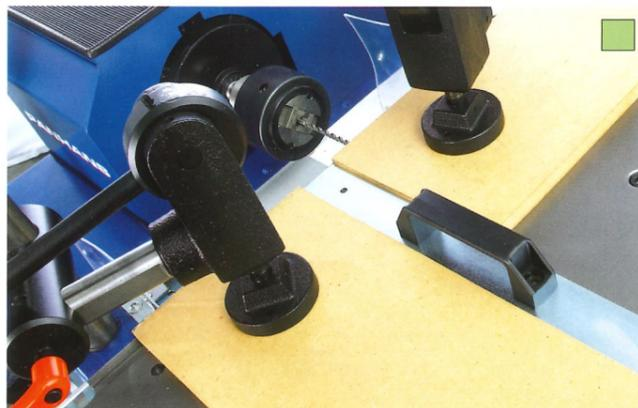
Steckbarer Rahmenanschlag mit 2 Stück Handexzenterspanner
