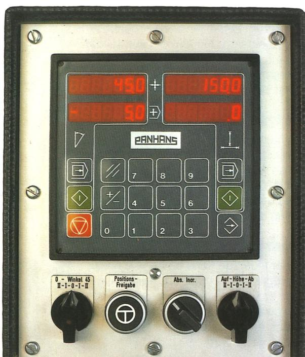
Als Sonderzubehör erfolgt die Höhen- und Schwenkverstellung über eine elektronische Positionier- und Programmsteuerung mit 1/10 mm Genauigkeit. Die Schaltung ist im Schwenkpult mit ständiger Anzeige von Soll- und Istmaß untergebracht. Die SpindelhöhenEinstellung hat Inkrementmaß-Umschaltung.
