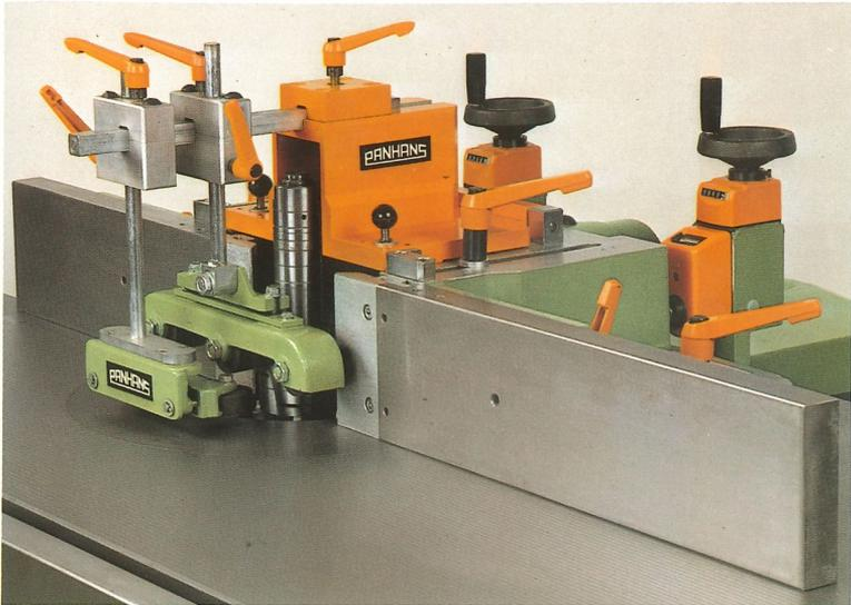
Sonderzubehör: Fräsansschlag zum Einstellen ohne Probefräsen. Die Anschlagbacken sind gemeinsam und einzeln verstellbar, Anzeige 1/10 mm Genauigkeit. Separate Digitalanzeige der eingestellten Frästiefe. Montagemöglichkeit für Vorschubapparat. Druck- und Führungsapparat ist separat.
