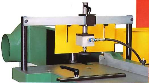
Pneumatische Spanneinrichtung mit einem Zylinder.
