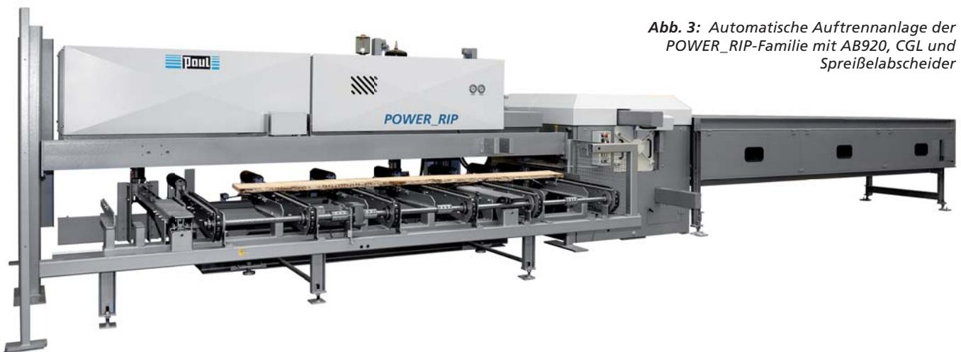
**Abb. 3:** Automatische Auftrennanlage der POWER\_RIP-Familie mit AB920, CGL und Spreißelabscheider
