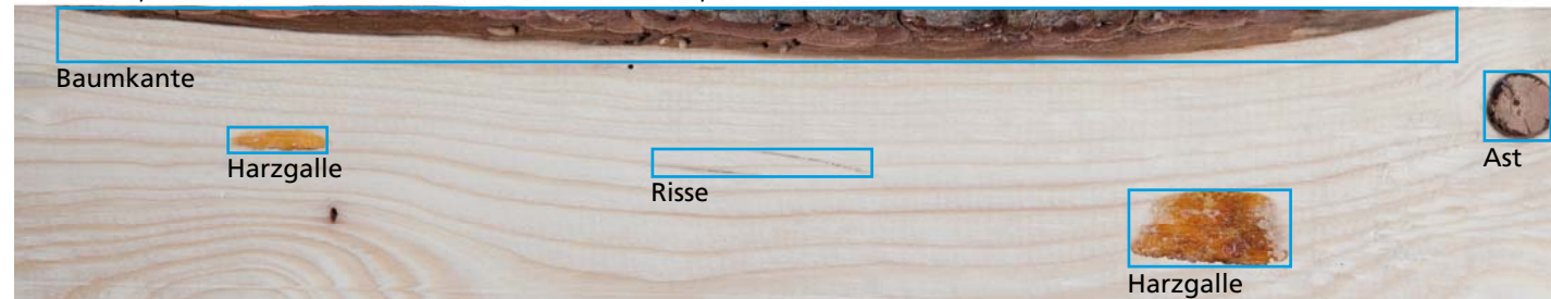
Abb. 3 Beispielhafte Holzmerkmale, die bei der Oberflächeninspektion erfasst werden
