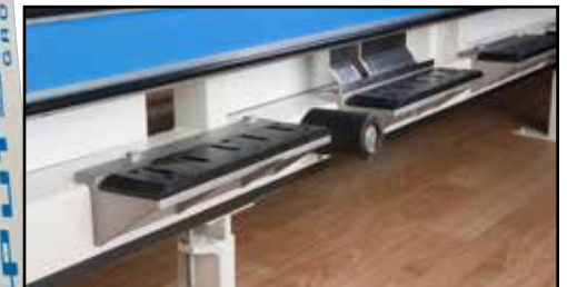
Die stabilen Plattenablagen werden durch einschwenkbare Transportrollen zum einfachen Plattentransport ergänzt.
