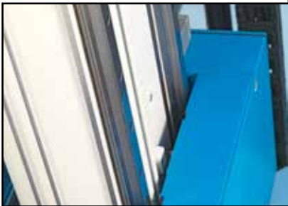
Lineare Präzisionsführungsschienen für höchste Schnittpräzision.
