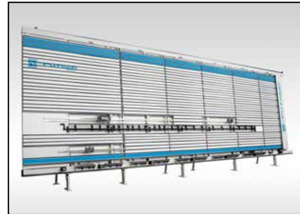
Grundrahmen mit Feinanlagerrost und TRK-Staubabsaugsystem.
