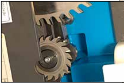
Manuell eintauchendes Vorritzer-Sägeaggregat mit Doppelsägeblatt und eigenem Antriebsmotor.
