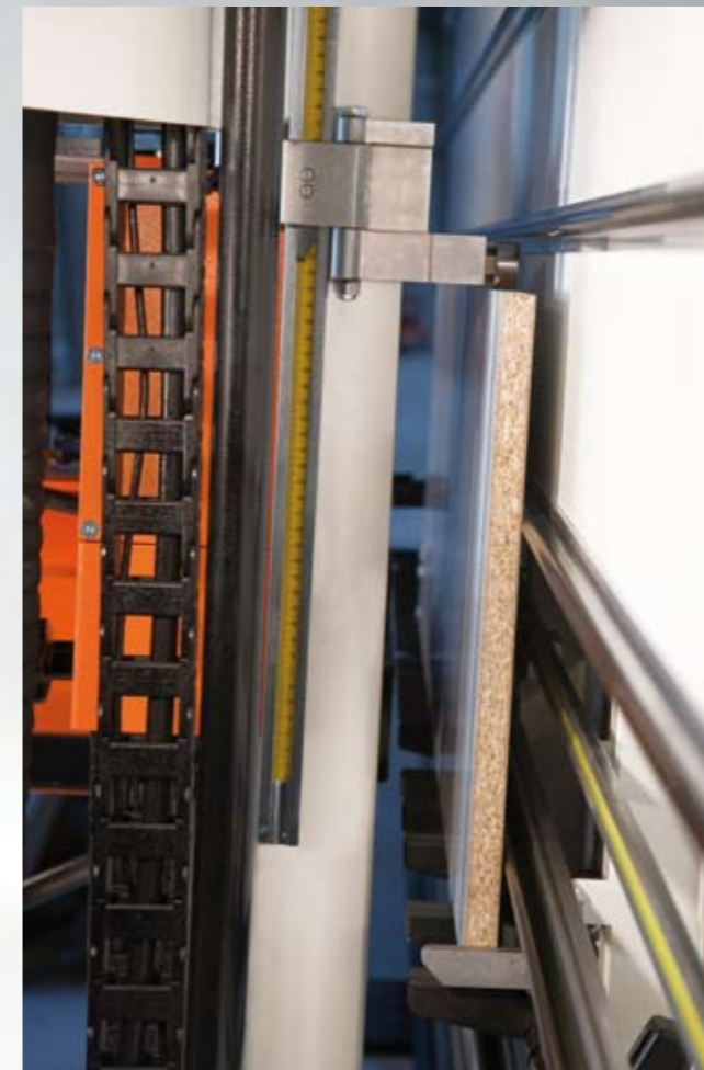
Dispositivo taglio strisce orizzontali. Repeat cutting device of horizontal strips. Dispositif corte tiras horizontals. Dispositif coupes de bandes repetitive en horizontale.
