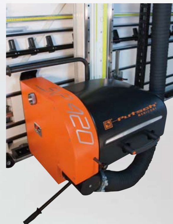
Dispositivo taglio strisce orizzontali. Repeat cutting device of horizontal strips. Dispositif corte tiras horizontals. Dispositif coupes de bandes repetitive en horizontale.
