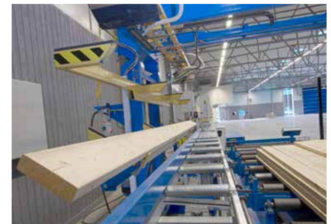
Deska jest gotowa do położenia lub przewrócenia na ławę podającą
