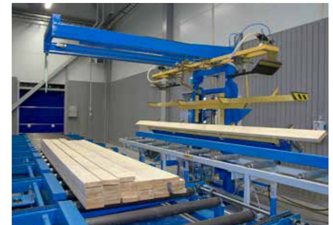
Podajnik tarcicy z dodatkowym przenośnikiem rolkowym
