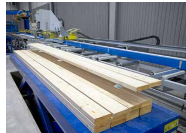
Sztaplarka gotowa do ułożenia warstwy na podnoszonym stole
