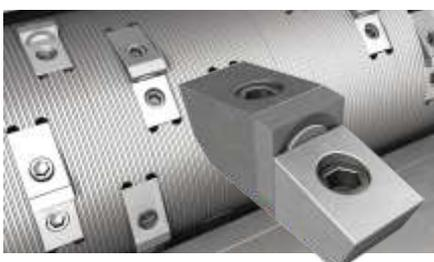
Das Schneidmesser mit waagrecht eingesetzten Vierkantmesser eignet sich speziell zur Herstellung von Granulat, welches in der Zellulose Fabrikation verwendet werden kann.
