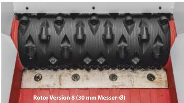
Die konkav gefrästen Rundschneidkronen ermöglichen einen sehr hohen Durchsatz bei geringem Kraftaufwand durch einen effizienten Scherenschnitt. Die Messerhalter sind auf dem profilierten Rotor geschraubt oder geschweißt.
