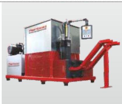
Série RB 400 RS : Pour une production industrielle de briquettes rectangulaires
