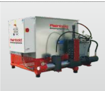
Série RB 100 – RB 300 Flexibel S : Pour une production journalière plus importante de briquettes à partir de copeaux et de sciure
