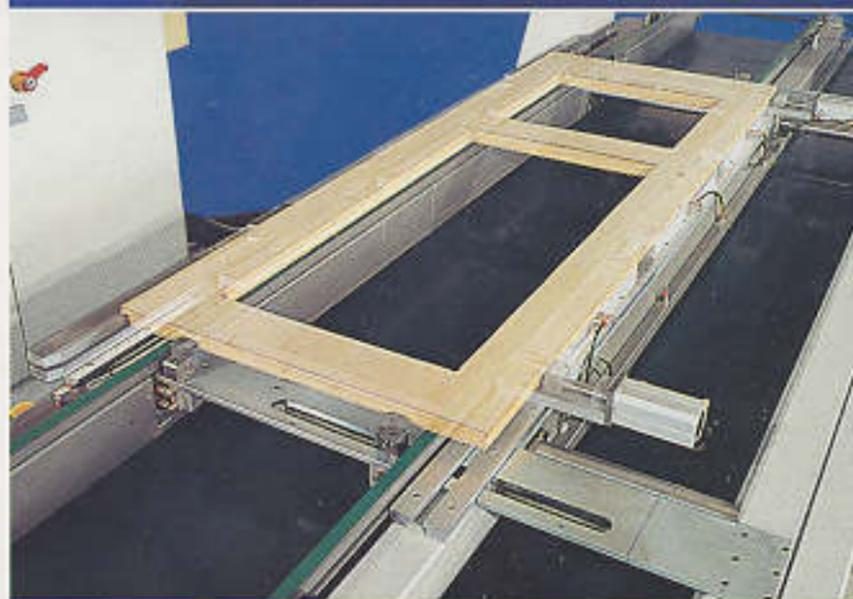
**Endanschlag:** befindet sich am beweglichen Portal und ermöglicht die Bezugsposition über das Programm anzuwählen, die sich entsprechend der jeweiligen Bearbeitungserfordernisse (z.B.: Türen mit Furnierüberstand oder Bogentüren) von Tür zu Tür ändern kann. So wird jede Tür je nach Größe und Bearbeitungsart immer auf die beste Weise ausgerichtet und der Aufwand für das Umrüsten der Spannvorrichtungen reduziert sich deutlich.
