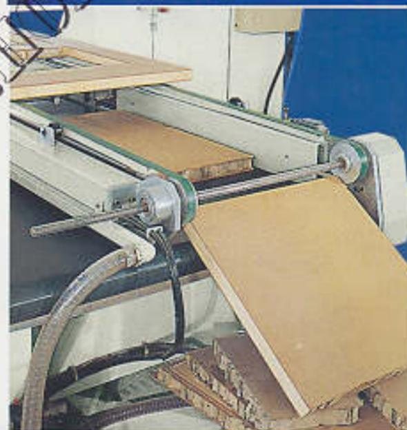
**Transportband zur Abfallentsorgung:** befindet sich unter den Trägern und sichert eine ständige und sichere Entsorgung der Holzreste zu.
