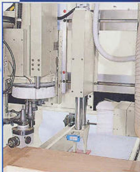
**Längsanschlag:** gestattet ein einwandfreies Ausrichten der Türen zur Gewährleistung einer einwandfreien Bearbeitung auch bei schon besäumten bzw. kantenverleimten Türen; er wird automatisch ausgeschlossen sobald der Ladevorgang beendet ist.
