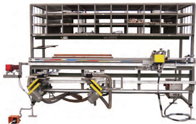
RU-BM-3000 Flügelmontagetisch mit Glasleistensäge
