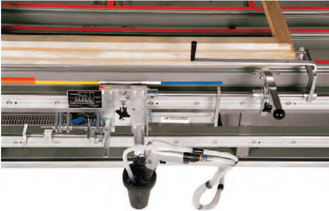
RU-BM-3000-E Flügelbeschlagsabastung mit handgeführtem Pistolenschrauber
