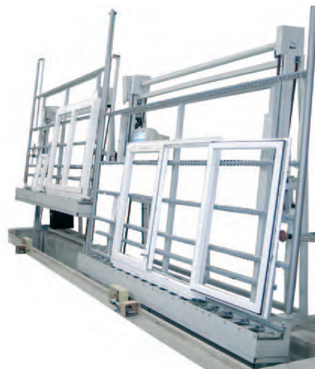
RU-SE Hubstation mit elektromotorischer Hubeinrichtung über und unter den Boden
