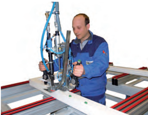
RU-CS-STZ-P Stabschrauber mit Zuführkanal, pneum. Vorschub und pneum. Positionieranschlag
