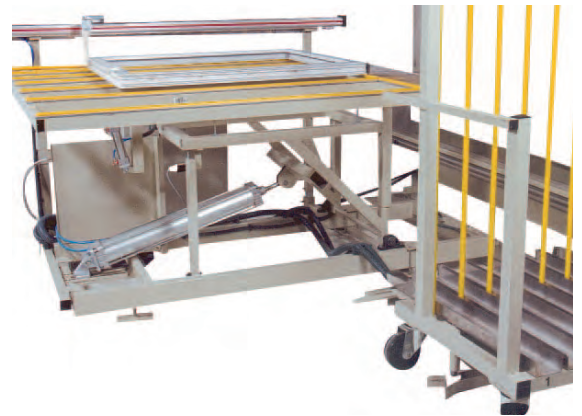
RU-AFKW automatische Kipp- und Abstellvorrichtung
