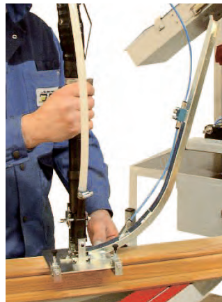
RU-CS-ST-Z Stabschrauber mit Aluhalter-Zuführkanal und Positionieranschlagen
