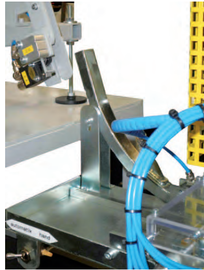
Autom. Befüllung vom Zuführkanal des RU-SZ-C-D in den Zuführkanal des RU-CSA-SM
