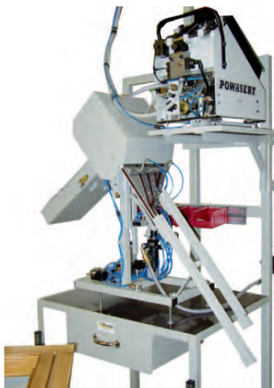
RU-SZ-C-D Sortier und Zuführeinheit für einen oder zwei Aluhalter
