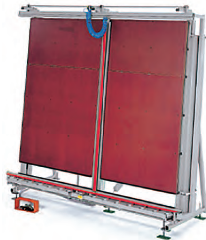
RU-VGT Hubstation mit Anpressvorrichtung von vorne für Trockenverglasung
