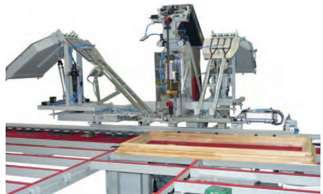
RU-CS-ZA Aluhalter-Setzautomat am Rahmen mit autom. Vorschub und zwei Schwingförderer
