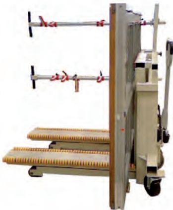
RU-HRW Hubrollwagen mit einstellbaren Haltebögen für Palettenverpackungen
