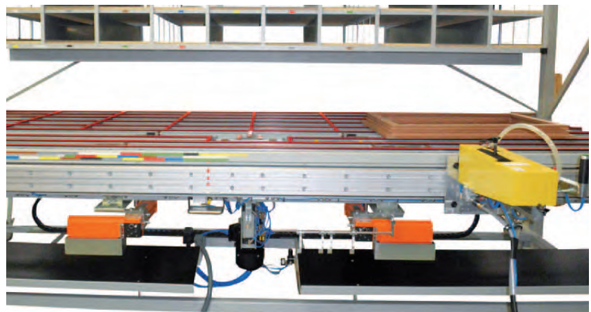
RU-BM-3000-Z Flügelmontagetisch mit Zentrier Einrichtung, Griffsitzbohrmaschine und zwei Beschlagstanzen
