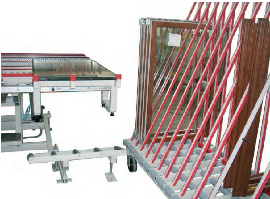
RU-FMOG Flügelmontagestation mit Flügelfachwagen
