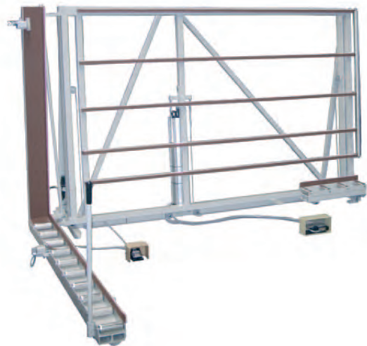
RU-SW 90° Hubstation mit Wendeeinrichtung
