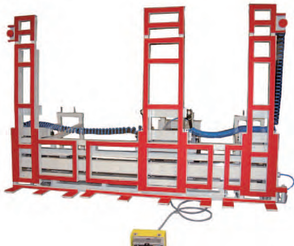
RU-MK-HS Montage-Kipptisch für Hebe-Schiebetüren (in Grundstellung)
