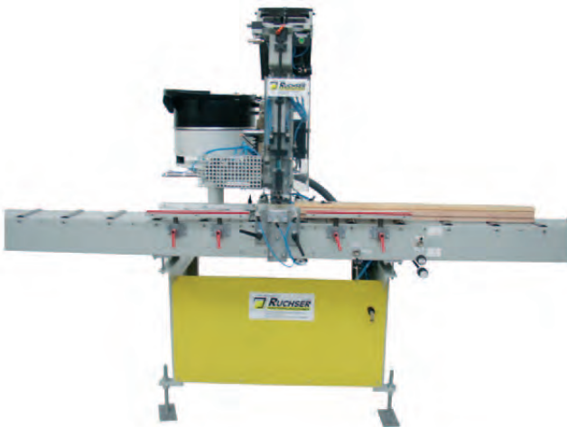
RU-CS-ZAE-M Aluhalter-Setzautomat am Einzelstab mit manuellem Vorschub
