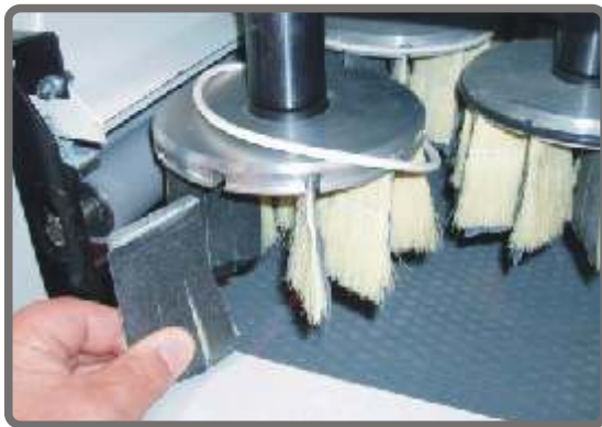
Disc brushing unit – exchange of inserts Disk Bürsten – die Futer Auswechslung Diskový kartáč- výměna insertu Dyskowa szczotka – wymiana segmentow listkowych Дисковые щетки – сменна оброзивных сегментов
