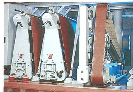
3 mal Segmentschleifschuh 1 x Querband + 2 x Breitband
