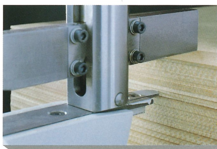
Gegenhalter zum Einschleiben dünner Platten
