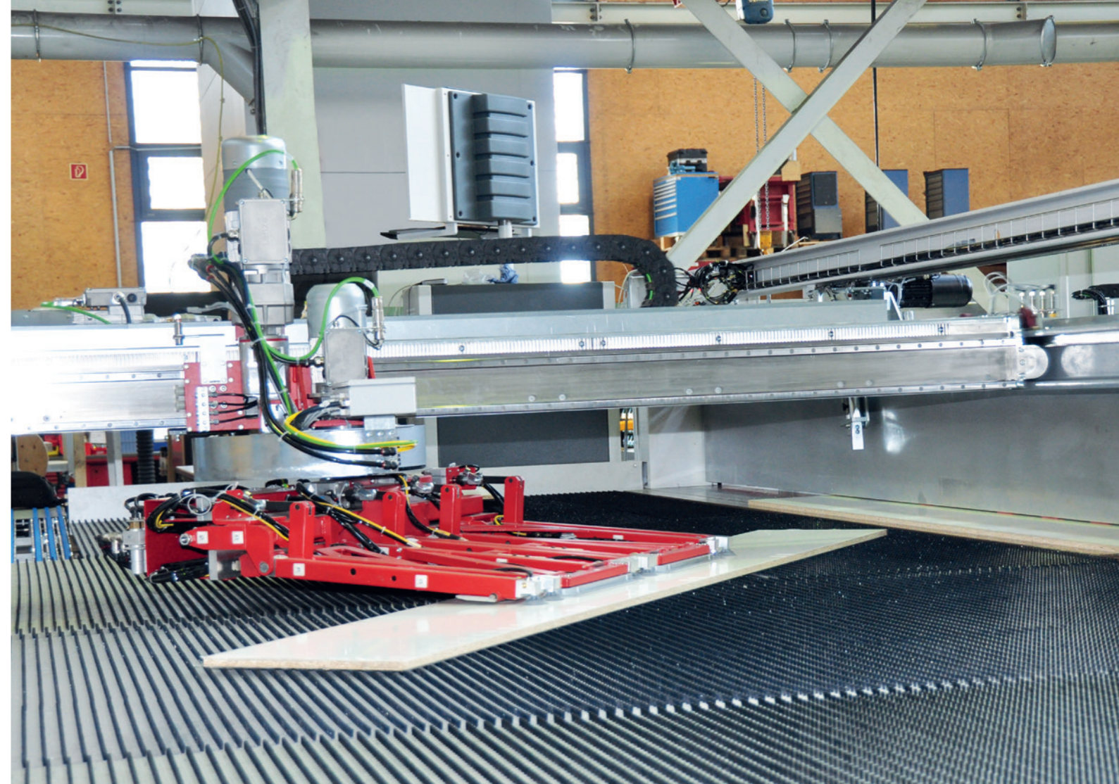
Der Umsetzwagen dreht jeden einzelnen Längs-Streifen um 90° und sammelt diese auf einem Pufferplatz in der Rückführstrecke
