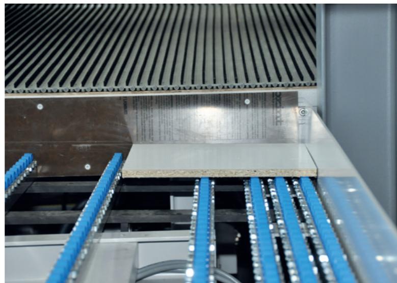
Großreste werden automatisch zurück ins Lager versorgt. Handreste werden vom Bediener in den automatischen Kreislauf wieder eingeschleust.
