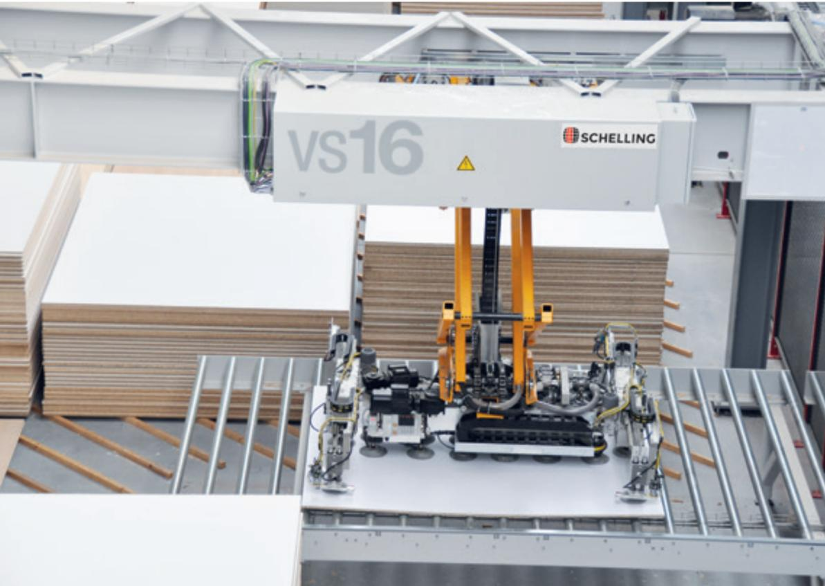
Gerade in der Losgröße-1-Fertigung ist die Verwertung von Resten grundlegend für die Wirtschaftlichkeit. Natürlich versucht die Schnittplanoptimierung in der industriellen Losgröße-1-Fertigung, die einzelnen Rohplatten vollständig zu verplanen, indem sie Teile verschiedener Aufträge zusammenfasst. Aber es liegt in der Natur der Einzelteilerfertigung, dass das nicht immer wirtschaftlich möglich ist.
