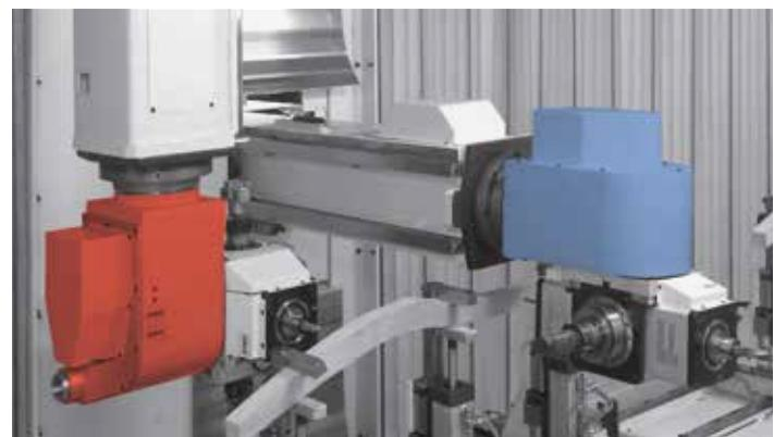
L'innovativa e UNICA geometria della macchina, con vie di corsa indipendenti, permette il completo interscambio delle unità operatrici in qualunque momento e in qualunque posizione con tutti gli elettromandrini delle unità operatrici "revolver".
