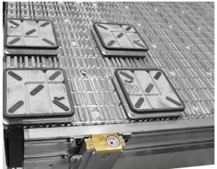
Die T-förmigen Nuten ermöglichen die starre Befestigung eventueller zusätzlicher Spanner, die nicht von SCM geliefert wurden. Es ist möglich den Arbeitstisch mit Saugern auszustatten, die gemäß Werkstücktyp und -geometrie frei befestigt werden.
