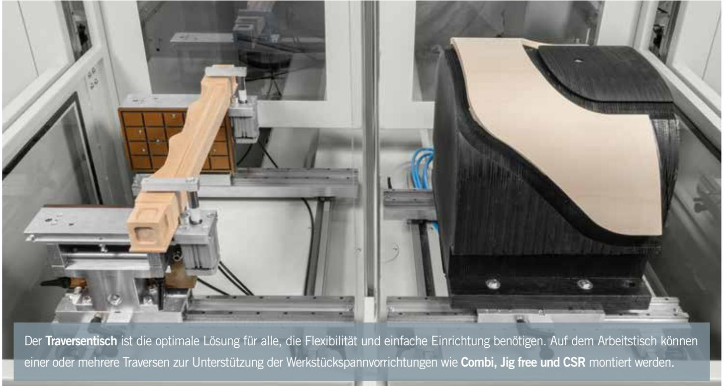
Der **Traversentisch** ist die optimale Lösung für alle, die Flexibilität und einfache Einrichtung benötigen. Auf dem Arbeitstisch können einer oder mehrere Traversen zur Unterstützung der Werkstückspannvorrichtungen wie **Combi**, **Jig free** und **CSR** montiert werden.
