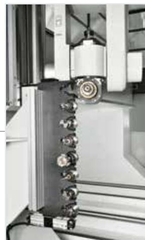
*Lineares Werkzeugmagazin an der Säule des Portals befestigt.*
