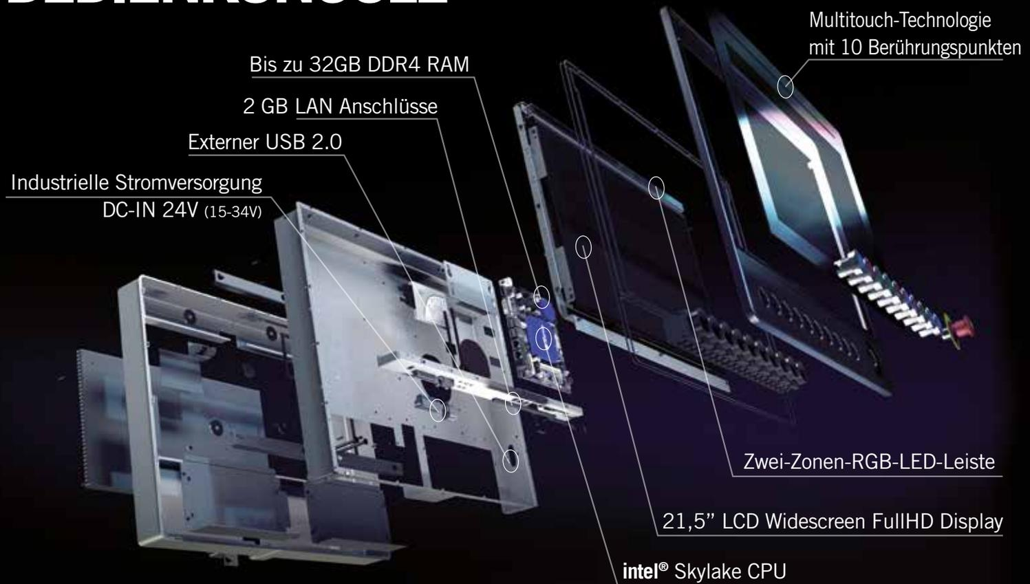
Bedientafel mit linearem Design, einfach und elegant, betont den "Vollbild" -Effekt.
