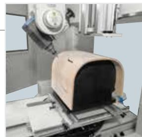
*5-Achs-Arbeitsaggregat mit Einzelelektrospindel doppelgerichtet oder Revolver mit automatischem Werkzeugwechsel und Flüssigkeitskühlung.*
