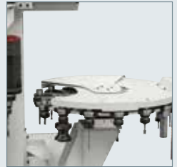
Disk tool store with 16/20 tool stations Scheibenmagazin mit 16/20 Stationen zur Werkzeugaufnahme
