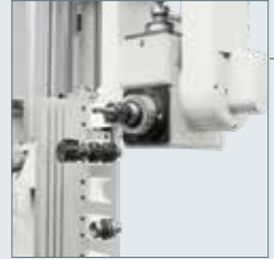
Rack tool store with 6/8 tool stations Lineares Magazin mit 6/8 Stationen zur Werkzeugaufnahme
