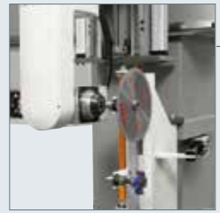
Tool changer - saw blade diameter up to 400 mm Werkzeugwechsel - Sägeblattdurchmesser bis zu 400 mm
