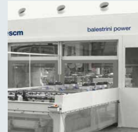
Upper cover for dust extraction Abdeckhaube und Absaugung von Spänen
