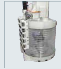
Dust extraction hood on operating unit PX5 Absaughaube für Stäube am PX5-Arbeitsaggregat
