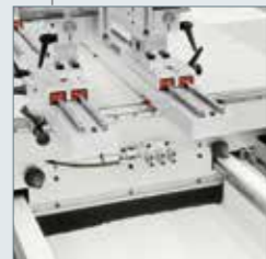
Fast locking devices for all crossbars and equipments Schnellspanner an allen Ausrüstungen und Traversen
