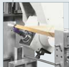
Axis-lathe system for machining cylindrical symmetry pieces Drehachsen-System zur Bearbeitung von Werkstücken mit zylindrischer Symmetrie
