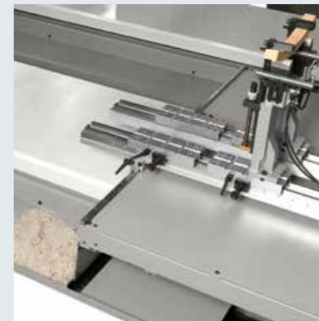
Spazzole per pulizia sfridi e trucioli Cepillos para limpieza recortes y virutas
