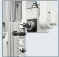
Magazzino a pettine con 6/8 stazioni per alloggiamento utensili Almacén herramientas de tipo estantería con 6/8 posiciones
