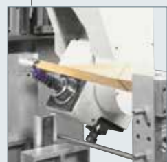
Sistema asse-tornio per la lavorazione di pezzi a simmetria cilindrica Sistema eje-torno para el procesamiento de piezas con simetría cilíndrica
