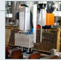
Unità a forare montata a lato del gruppo operatore birotativo Unidad de taladrado montada a lado del cabezal birotativa
