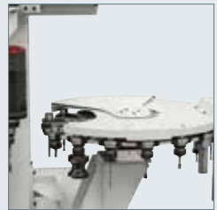
Magazzino a disco con 16/20 stazioni per alloggiamento utensili Almacén herramientas circular con 16/20 posiciones
