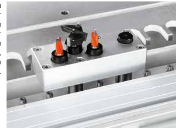
Aggregate für Topfbandbohrungen Damit die Maschine für noch mehr Bearbeitungen verwendet werden kann, können die Spindeln mit verschiedenen optional erhältlichen Bohrköpfen ausgestattet werden, mit denen Sie Scharnieraufnahmen herstellen können.
