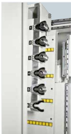
*Maximale Flexibilität* mit allen erforderlichen Werkzeugen und Aggregaten immer an Bord dank des automatischen 6-Positionen Werkzeugwechslers.
