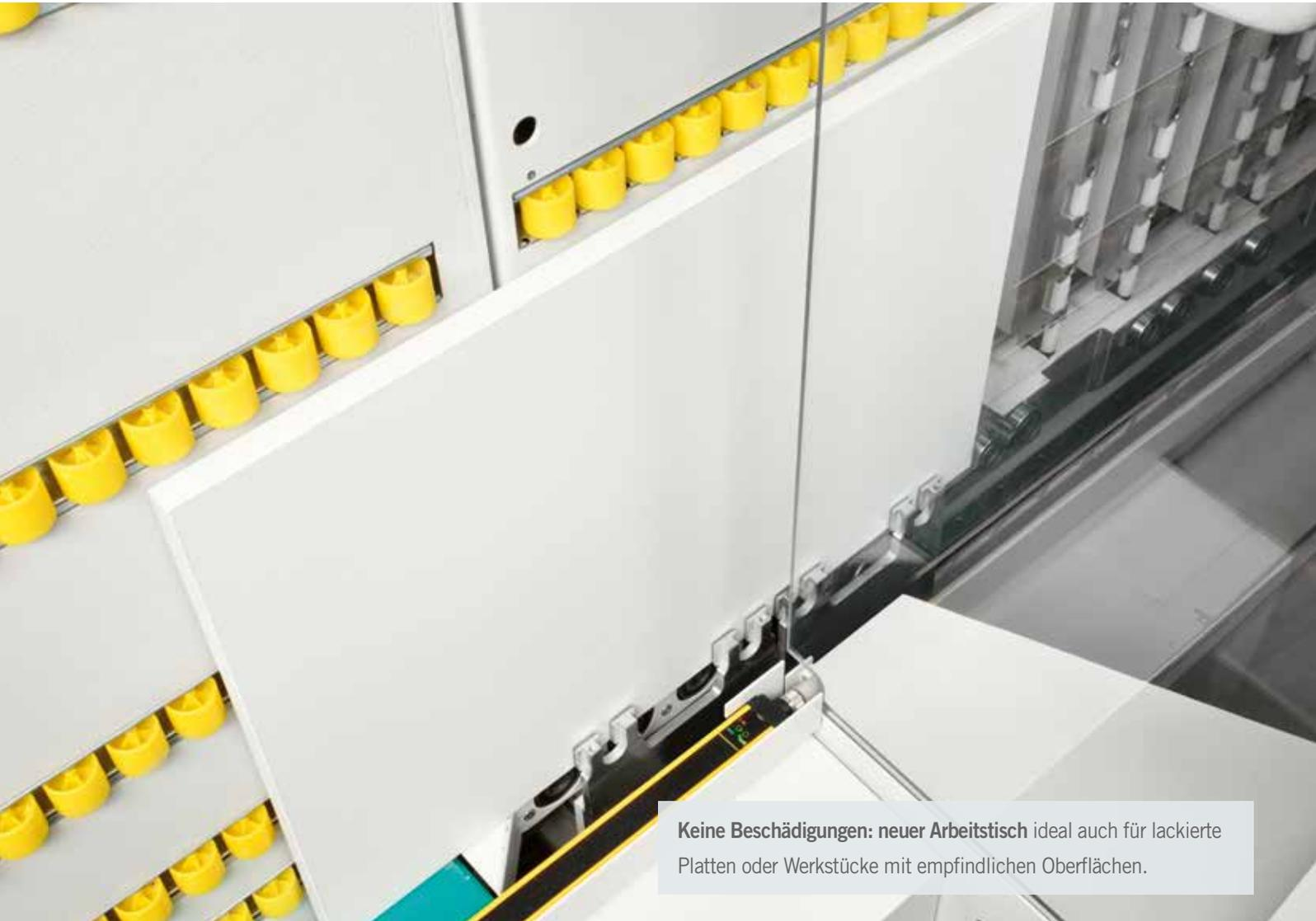
**Keine Beschädigungen:** neuer Arbeitstisch ideal auch für lackierte Platten oder Werkstücke mit empfindlichen Oberflächen.
