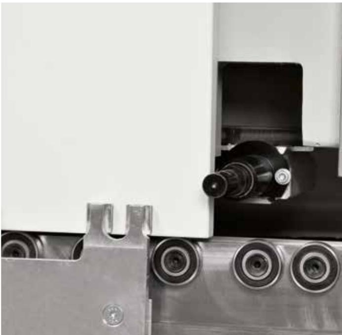
Schnelle und präzise Plattenbeladung: **einstellbarer mechanischer Referenzanschlag.**
