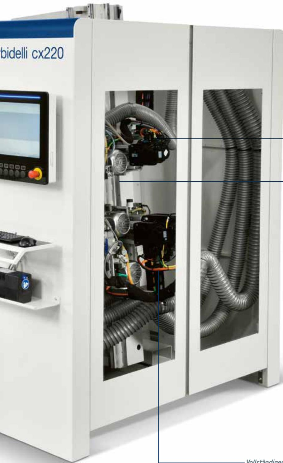
*70% Zeitersparnis beim Bohren mit den 2 Bohrköpfen mit je einer unabhängigen Y und Z Achse, die gleichzeitig arbeiten.*
