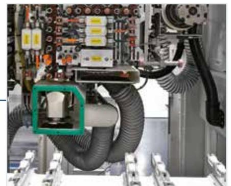
*Nicht nur Bohren: Aggregat für "Clamex" Verbindungen.*
