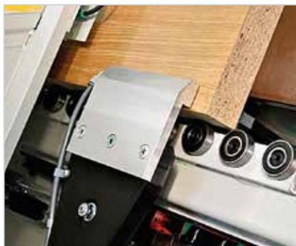
*Absolut sicheres Handling des Werkstückes mit präziser Verarbeitungsqualität dank der stufenlos klemmenden Spannzange die keinerlei Rüstzeit benötigt.*
