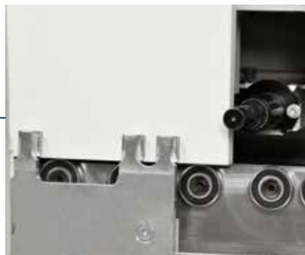
*Geformte NC- Spannzange*, um alle notwendigen Bohrungen ohne Neupositionierung durchzuführen und den Bearbeitungszyklus zu beschleunigen.
