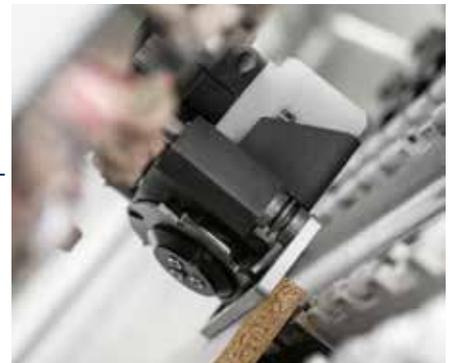
*Nicht nur Bohrungen:* Aggregat für das Fräsen von "Clamex" Verbindungen.
