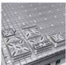
**Sehr hohe Flexibilität des Multifunktions-Arbeitstisches** aus gepressten Aluminium, **extrem starr**, um immer eine **perfekte Ebenheit zu gewährleisten**, auch nach wiederholten mechanischen Belastungen; ist ebenfalls ideal für die Nesting-Bearbeitung.
