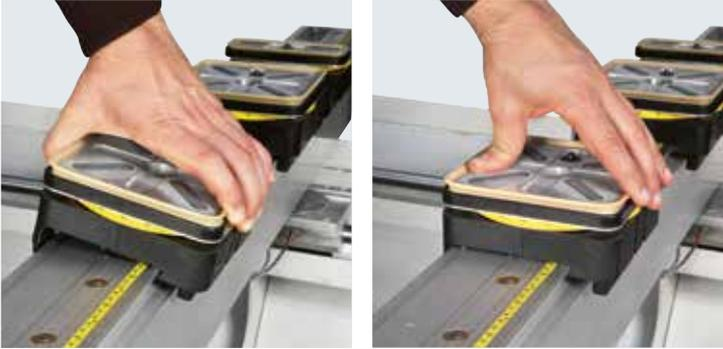
Es ist möglich Sauger oder Spanner mit einer einfachen Handbewegung hinzuzufügen oder zu entfernen; die Anzahl und die Position werden automatisch erfasst.
