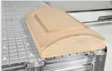
Die Anordnung der Vakuumkanälen in der Oberfläche des Arbeitstisches ermöglichen eine einfache und schnelle Positionierung von Aufspannvorrichtungen wie die MPS Sauger oder das praktische MODULSET System mit zusammensetzbaren Modulen.
