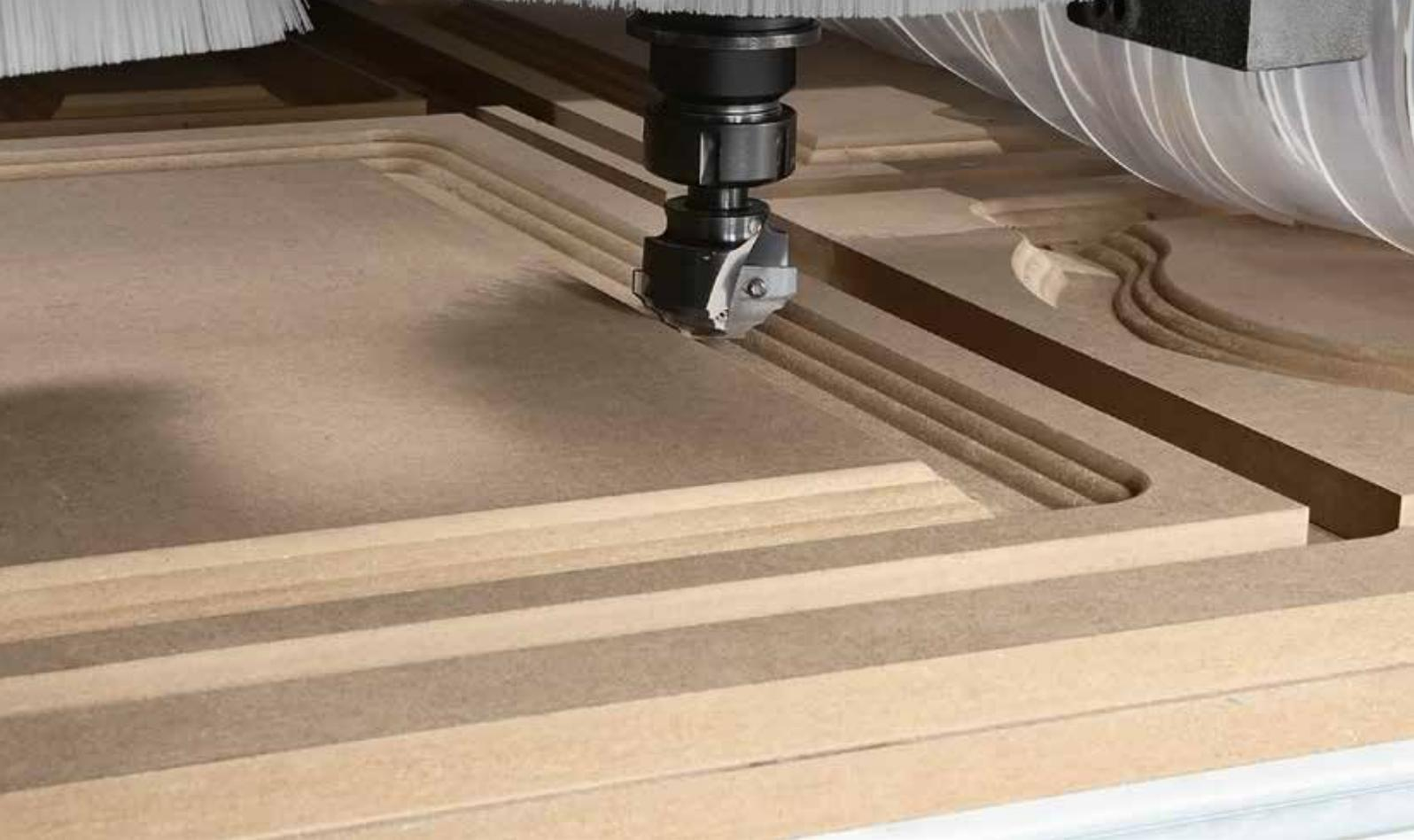
*Optimale Bearbeitungspräzision mit der 3-achsigen Elektroschindel bis zu 24.000 U/min.*
