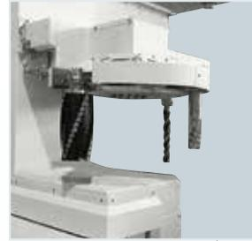
Einbaumöglichkeit für, ein **zusätzliches Werkzeugmagazin** mit Spannzangen mit pneumatischer Auslösung, speziell für schwere Werkzeuge.
