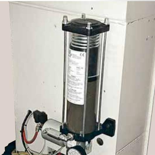
**Automatische Zentralschmierung**, die über die Steuerung verwaltet wird (Std.).
